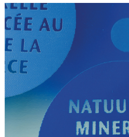
用UV油墨印刷出亮麗色彩和邊緣清晰的圖像。使用SEFAR PCF 120 / 305-34Y絲印網紗
