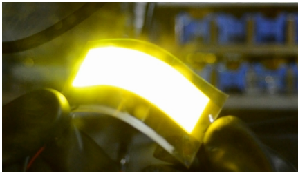
在SEFAR TCS Planar上印制的大尺寸柔性OLED。由CSEM在CTI项目中制造。
