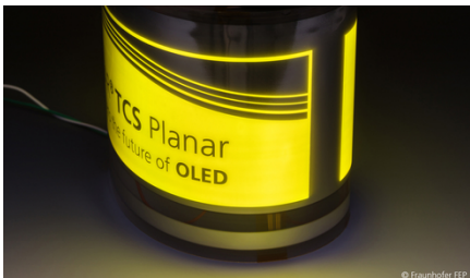
SEFAR TCS Planar上的大尺寸柔性OLED，采用roll-to-roll真空工艺并封装。其由Fraunhofer FEP制造。
