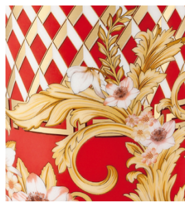
Четкое воспроизведение изображения на керамических деколях, получено с использованием сетки SEFAR PET 1500 (© Rosenthal)
