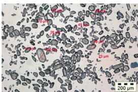
Предлагаемый размер пор варьируется от 5 мкм до более чем 150 мкм для фильтрации различных взвесей. В зависимости от свойств
