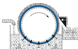
Descarga de pré-revestimento
