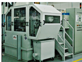
Filtres à bande sous vide
