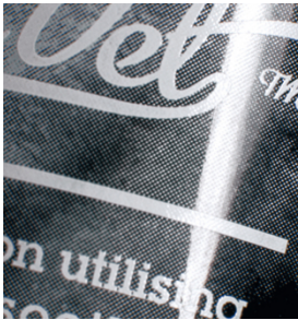
Feiner Raster auf Kunststofftuben, gedruckt mit SEFAR PCF FC
