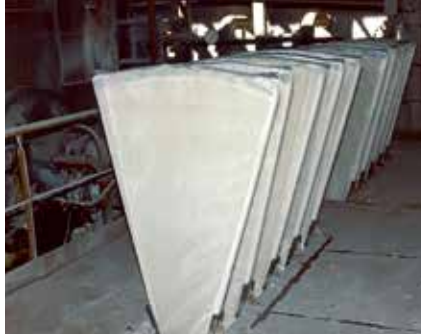
Montaja hazır filtre segmentleri
