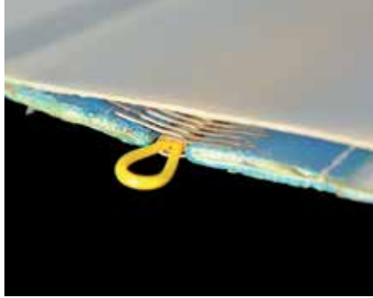
Belt birleştirme Üstten korumalı metal kliper birleştirme
