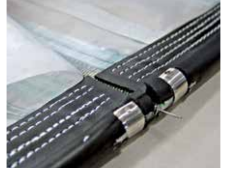
Özel kauçuk profilli bant birleştirme
