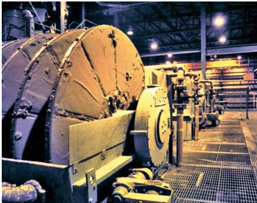
Obrotowy Filtr Tarczowy do odwadniania rudy
