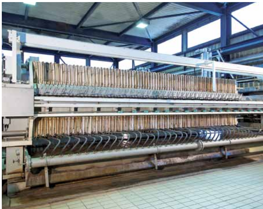
Prasa filtracyjna z automatycznym usuwaniem osadu
