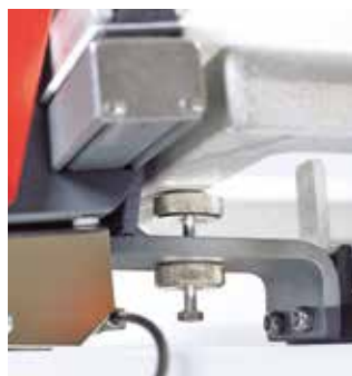
Tornillo para ajustar la altura del marco a tensar con SEFAR® 3A
