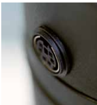
Interfaz serial RS 232 de SEFAR® Tensoscheck 100i
