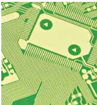
100 μm 도체 패턴 - SEFAR® ELECTRONICLINE 120/305-35Y를 사용한 내식성 무오류 제판 제조
