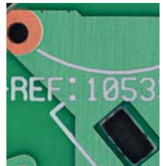
SEFAR® ELECTRONICLINE 100/255-40Y를 이용해 구현한 선명한 레전드 인쇄
