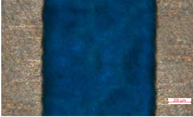
그림 2: SEFAR® ELECTRONICLINE 120/305-35Y로 프린트된 부식 방지 패턴
