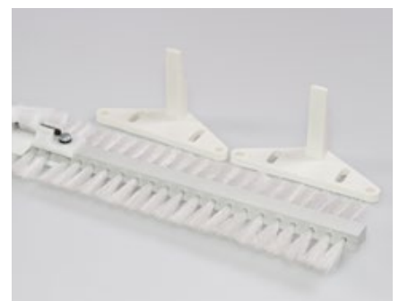
Griessputzbürsten mit 2 Richtungswechslern in den Breiten 465 und 510 mm
